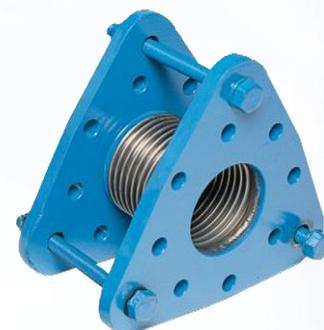
NOTA • Modelo TCS-R clasificado para compresión de 1", extensión de 3/8", vibración lateral y de la bomba de 1/8" -5/16". (Según el tamaño)
